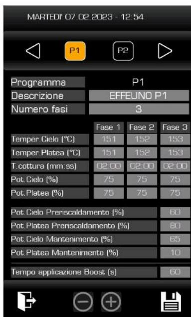
Per ciascuno dei 30 programmi è possibile modificare il nome (attraverso un tastierino alfanumerico che appare a schermo), il numero di fasi e, come parametri, il set-point di temperatura di cielo/camera, il tempo di cottura, le percentuali di cielo/platea e le percentuali da applicare nella modalità preriscaldamento e mantenimento.
