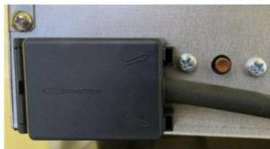
Una volta scattato l'intervento della sicurezza, per far riprendere regolarmente il forno, staccare la corrente, e premere il pulsante posto sul termostato di sicurezza sulla parte posteriore forno, fino a completo riarmo.
