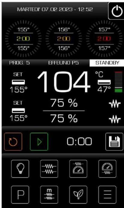
Nel caso il programma caricato abbia più di una fase, tali fasi vengono visualizzate sulla parte superiore del display e vengono rappresentate da corone circolari le cui barre vengono colorate con lo scorrere del tempo.
