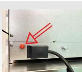
Nachdem die Sicherung ausgelöst wurde, gehen Sie wie folgt vor, um den Ofen regulär neu zu starten: trennen Sie die Stromversorgung, schrauben Sie die rote Kappe ab und drücken Sie die Taste des Sicherheitsthermostats auf der Rückseite des Backofens, bis er vollständig zurückgestellt ist.
